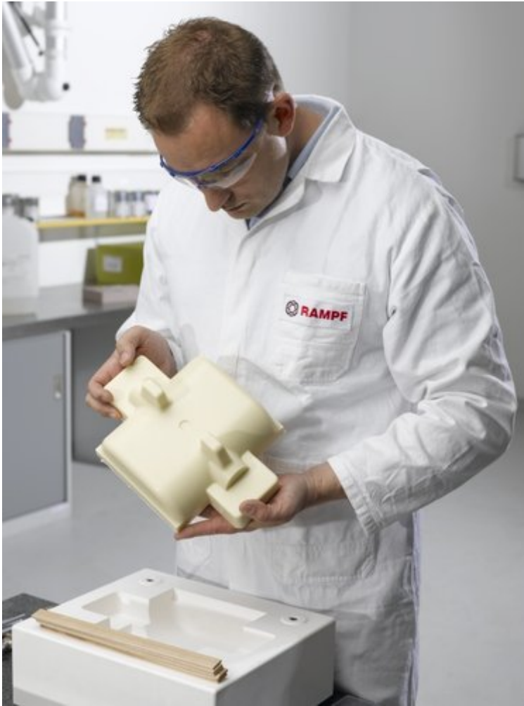
Выемка образца продукции лицевого/поверхностного литья, выполненного из системы RAKU-TOOL® PC-3451/PH-3952
