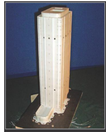
Малюнок 5: Архітектурні аеродинамічні моделі спроектовані з отворами під герметичні пробки, щоб уникнути часу та витрат на ручне свердління.
