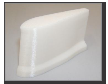
Малюнок 3: вертикальна орієнтація цієї моделі дає гладку поверхню, яку не потрібно додатково обробляти.
