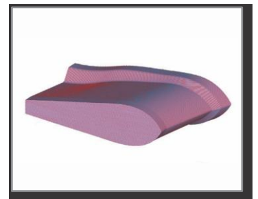
Малюнок 2: При цій орієнтації головна Поверхня крила матиме ступінчасту структуру, що впливатиме на потік повітря.
