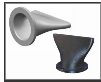
Малюнок 4: Випускне сопло для задньої шини від Joe Gibbs Racing car. CAD модель (ліворуч), FDM модель (праворуч).
