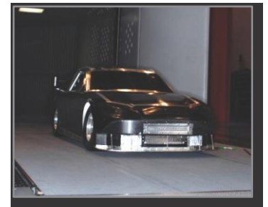
Мал. 1: Команди NASCAR використовують Повітряну трубу з рухомою підлогою для аналізу аеродинаміки їх гоночних машин.
