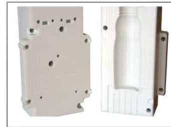
Малюнок 8: FDM оснастка, вироблена з полікарбонату.
