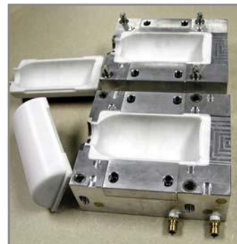
Figure 9: Гібридна оснастка FDM з контурною закладною
