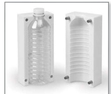
Малюнок 3: Видувна форма, вирощена з матеріалу FDM.
