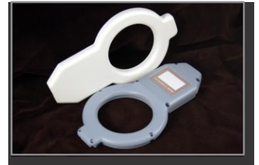
Рисунок 1: Пристрій FDM, пофарбований для відповідності готовому екземпляру
