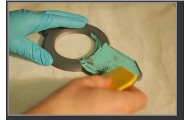
Рисунок 5: Нанесення шпаклівки у порожнини між шарами
