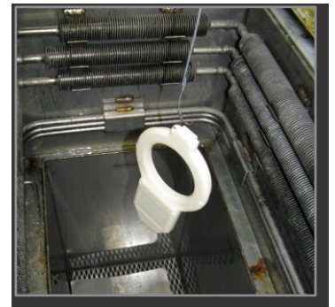
Рисунок 4: Автоматичне згладжування поверхні у камері з метилен хлоридом
