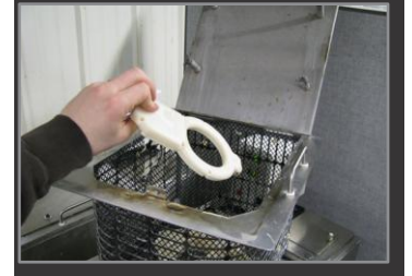
Рисунок 3: Видалення деталі з вимивної установки після розчинення підтримки
