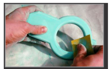
Рисунок 7: Після висихання шпаклівки, пошліфуйте деталь до необхідної якості
