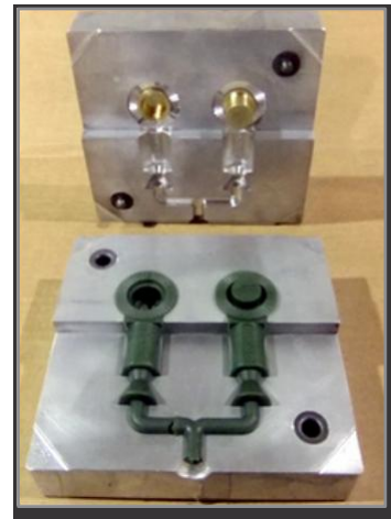
Типовий приклад алюмінієвої інжекційної форми та воскової моделі.
