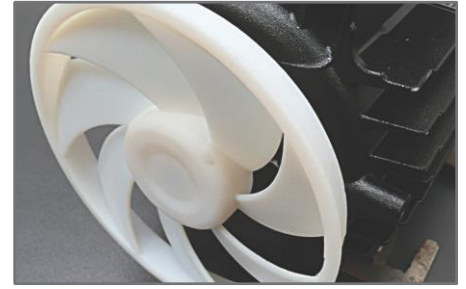
Надрукований вентилятор на вісі двигуна для тестування
